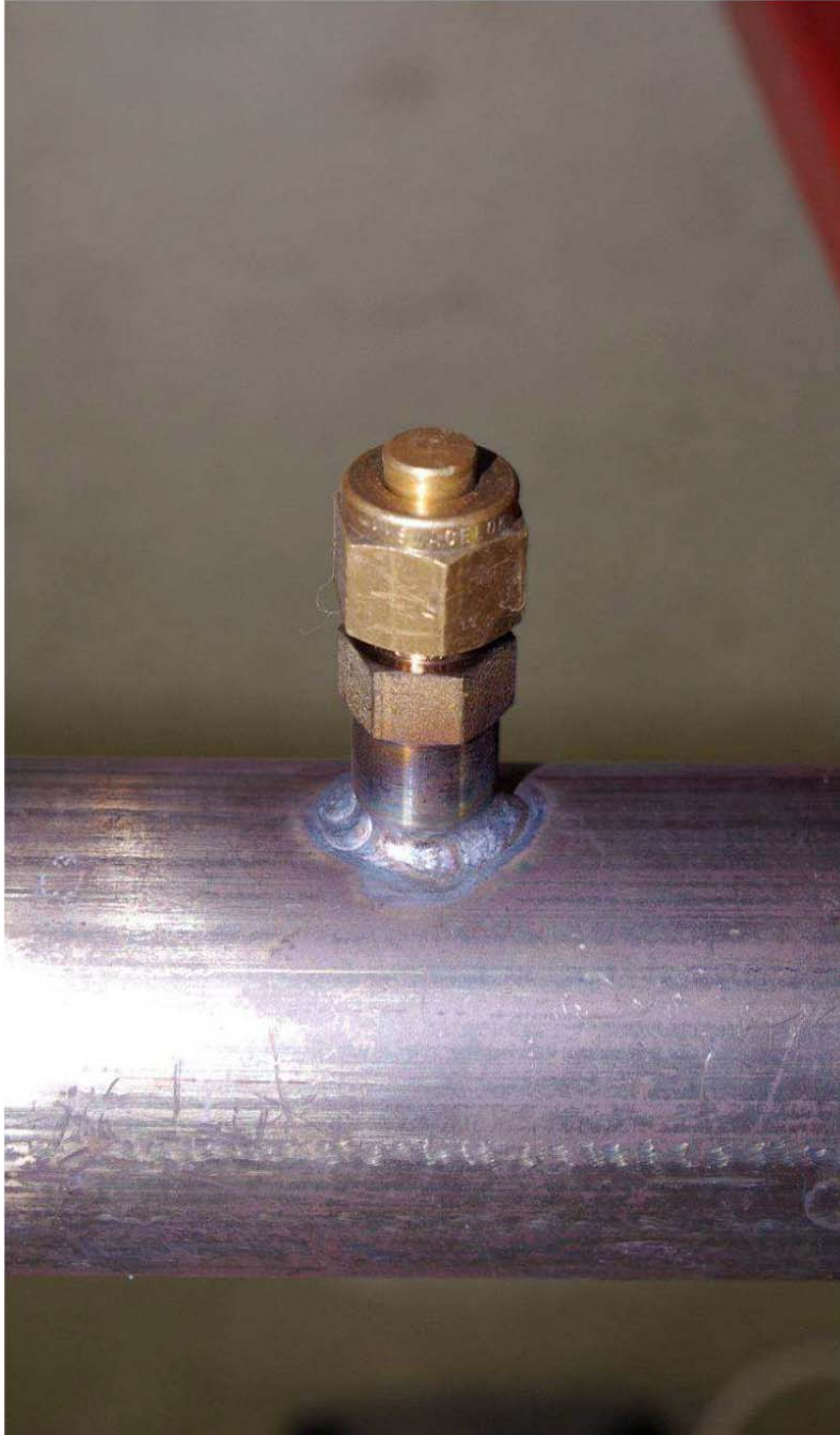
Fig. 2 : エキゾースト管へ Swagelok 継手を溶接し、メクラ栓を取り付け
