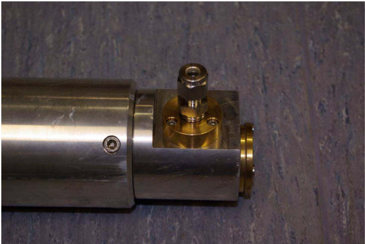
Fig. 1 : Swagelok のメールコネクタ「SS-6M0-1-4RT」を取り付けた加熱ライン
